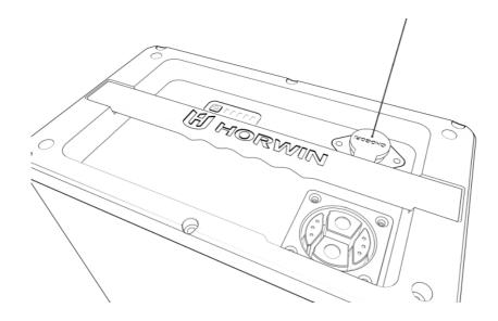
Nehmen Sie die Batterie heraus, stecken Sie das Ladegerät in die Ladeschnittstelle, dann in die Steckdose und drücken Sie den Startknopf der Batterie. Dann leuchtet die Stromanzeige auf und zeigt die Leistung in Echtzeit an.
