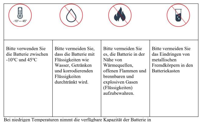
unterschiedlichem Maße ab. Zum Beispiel: Die verfügbare Kapazität beträgt 70% bei 10°C, 85% bei 0°C und 100% bei 25°C.
