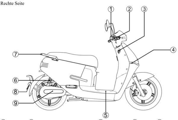
①Gashebel ②Rechter Kombinationsschalter ③Zündschloss ④Blinker ⑤Trittbrett ⑥Hinterer Stoßdämpfer ⑦Hintere Armlehne ⑧Reflektor ⑨Dekorative Abdeckung der Hinterradgabel
