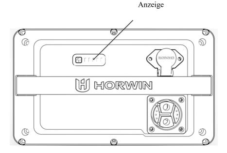
Im Normalzustand zeigt die Anzeige die Batterieleistung an. Jede Einheit gibt 20% der Leistung an.
